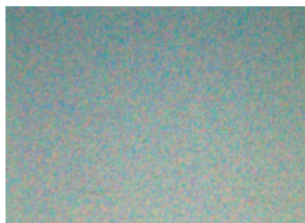
Bild 6: Glitzern eines weißen Bildschirms in Kombination mit einer mattierten Entspiegelungsschicht. Das wahrgenommene Muster verändert sich stark mit der Richtung der Betrachtung
