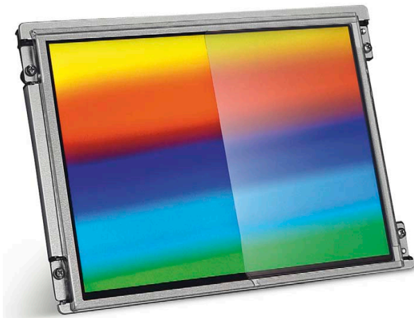
Bild 5: LCD-Modul mit optisch angekoppeltem Touchscreen (links) und nicht optimierter Kombination (rechts) mit ausgebleichten Farben und stark reduziertem Kontrast [6]
