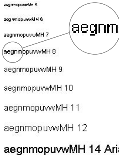
Darstellung von Zeichen unterschiedlicher Größe in der ›passenden‹ Pixelmatrix eines LCD-Bildschirms (links) und um den Faktor 1,28 hochgerechnet (rechts), was einer Vergrößerung von 800 x 600 auf 1024 x 768 Pixel entspricht. Durch die Hochrechnung ergeben sich Effekte, die die Zeichen in ihrem Aussehen stark verändern und die Erkennbarkeit oft drastisch verschlechtern.
