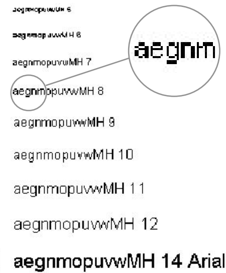
Darstellung von Zeichen unterschiedlicher Größe in der ›passenden‹ Pixelmatrix eines LCD-Bildschirms (links) und um den Faktor 1,28 hochgerechnet (rechts), was einer Vergrößerung von 800 x 600 auf 1024 x 768 Pixel entspricht. Durch die Hochrechnung ergeben sich Effekte, die die Zeichen in ihrem Aussehen stark verändern und die Erkennbarkeit oft drastisch verschlechtern.
